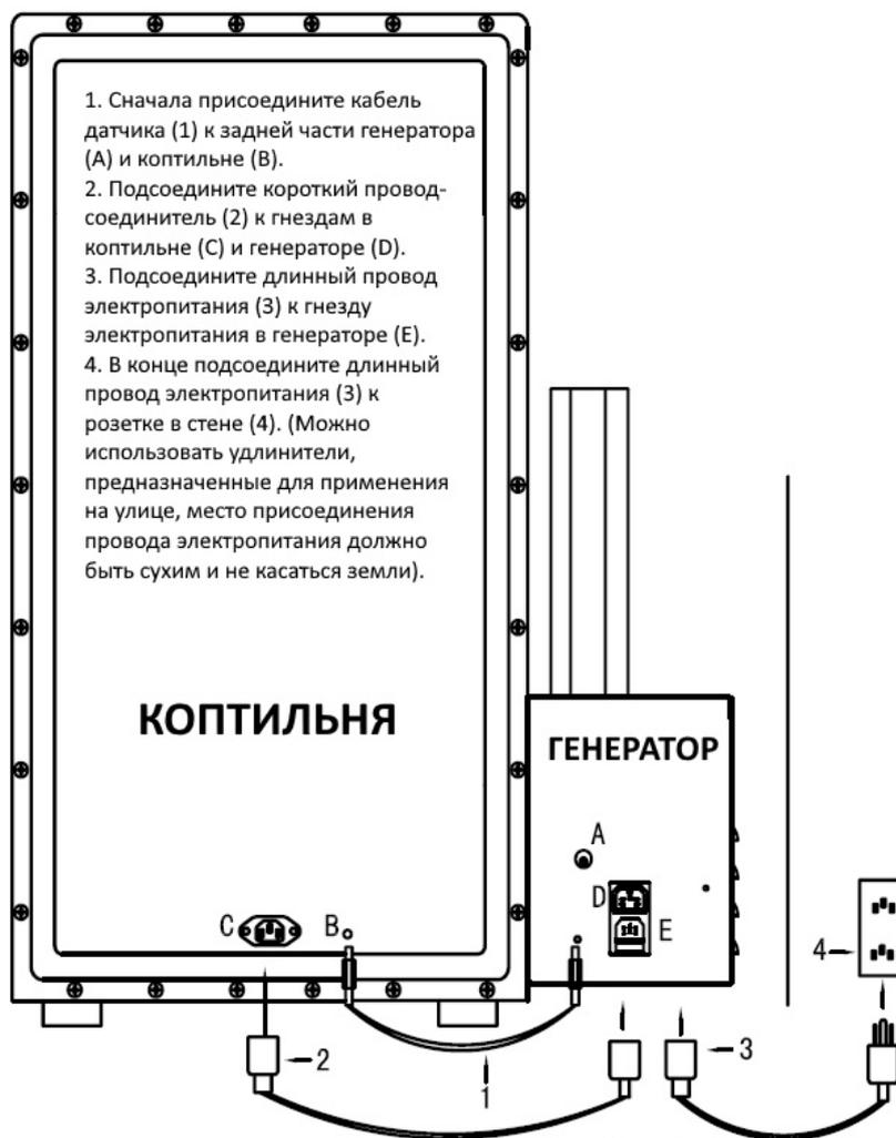
1. Кабель датчика (только цифровые коптильни)
