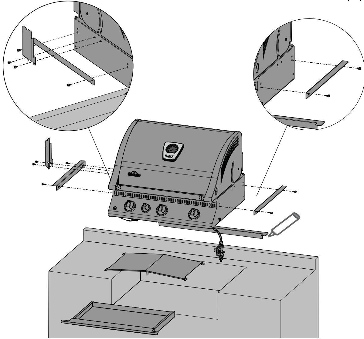
Данный гриль предназначен для установки в кирпичной кладке, корпусах только из НЕГОРЮЧИХ материалов. Установка и обслуживание должны производиться квалифицированным специалистом в соответствии с местными нормами.
