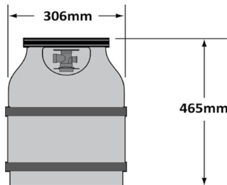
**Подключение баллона:** Снимите крышку или заглушку с вентиля баллона. Присоедините регулятор давления к вентилю баллона. Перед использованием гриля проверьте герметичность всех соединений. Испытание на герметичность должно проводиться один раз в год, а также каждый раз при подключении нового баллона или при замене какой-либо из частей газовой системы.
